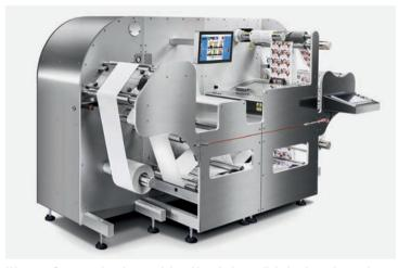
Werosys Compact ist eine modulare Verarbeitungslinie in einem kompakten und flexiblen Design. Sie ermöglicht dank hochwertigster Komponenten Geschwindigkeiten von 65 m/min in Halbrotation und 200 m/min in Vollrotation.
